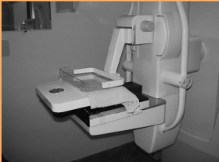
Figura 25 - Arranjo do teste da força de compressão
